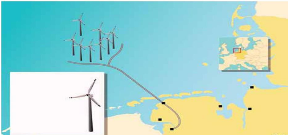
شکل (۲) : نمونه ای از اتصال برق نیروگاه بادی فراساحلی به شبکه برق خشکی
