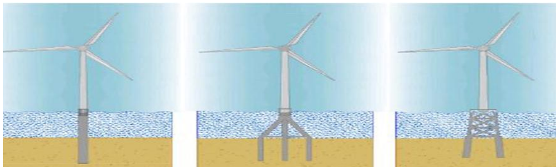
شکل (۷): سازه های تکیه گاهی Tripod, Monopile و Jacket
