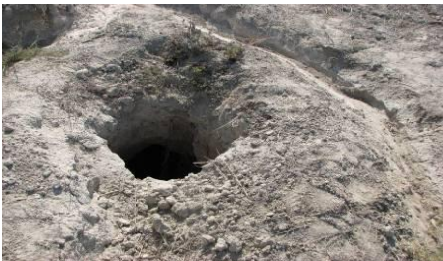
شکل ۱۱: منافذ ایجاد شده که بیشتر شبیه به چاهکهایی با عمق بیش از ۱ متر می باشند
