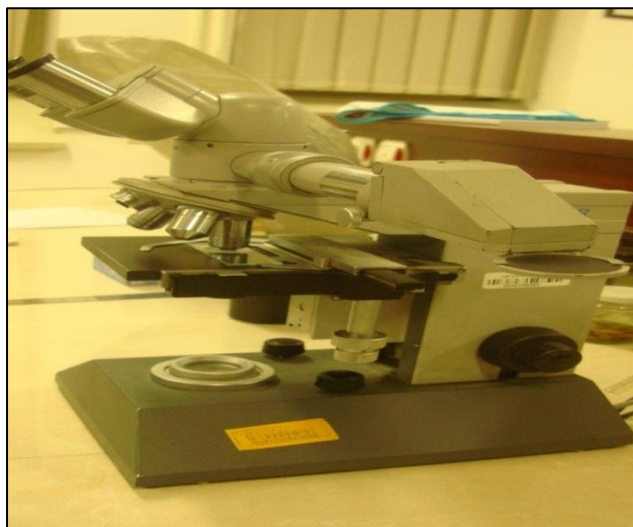
شکل ۳. استرئومیکروسکوپ با لوله ترسیم یا Drawing tube (مدل wild m3) (عکس از نگارنده)
