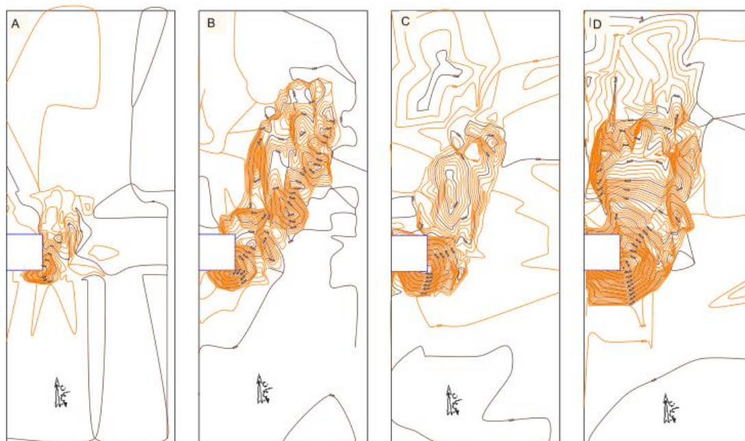
شکل ۳- و وضعیت توپوگرافی بستر اطراف کوله پل در پایان آزمایشات شاهد
