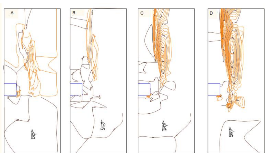
شکل ۴- و وضعیت توپوگرافی بستر اطراف کوله پل در پایان آزمایشات اصلی
