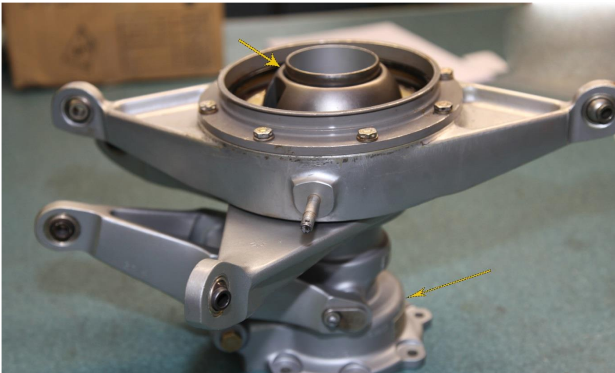
شکل ۳: قطعات Support و Sleeve در مجموعه Swashplate
