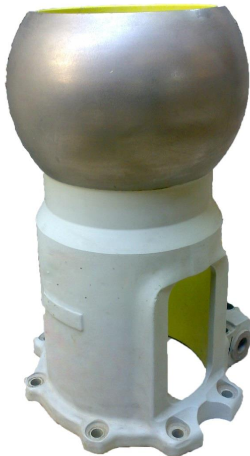
شکل ۶: قطعه Support از مجموعه Swashplate بالگرد ۲۱۴ با پوشش الکترولس نیکل - تفلون
