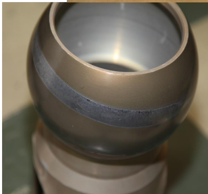
شکل ۱: نمونه Support بالگرد ۲۱۴ که معیوب شده است و نیاز به احیا دارد.
