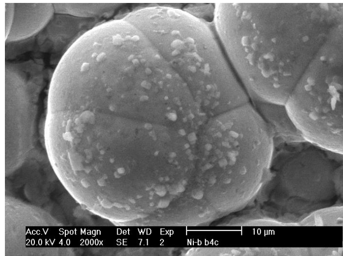
شکل ۳: تصویر تهیه شده توسط میکروسکوپ الکترونی روبشی از توزیع ذرات کاربید بور در پوشش نیکل-بور
