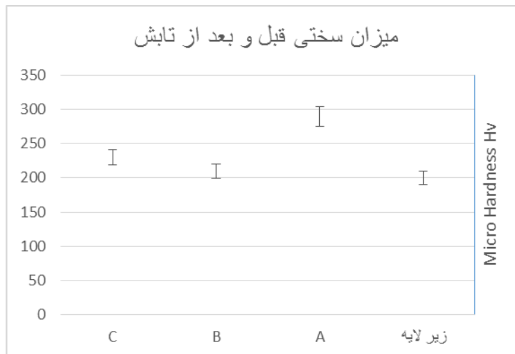
شکل ۳: نتایج سختی سنجی قبل (زیر لایه) و پس از تابش در نواحی C, B, A نمایش داده شده در شکل ۲
