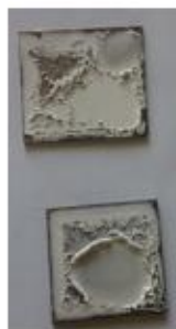
شکل ۴ شکل ظاهری لعاب اعمالی با سیلیس کلونیدی به عنوان محیط واسطه جایگزین آب (نمونه ۲)
