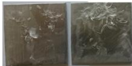
شکل ۵ شکل ظاهری لعاب اعمالی آب با چسب CMC بعد از خشک شدن در هوا (نمونه ۲)
