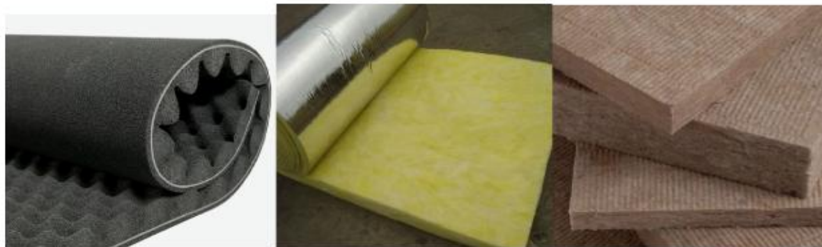
شکل ۱: انواع عایق های صوتی (پشم سنگ، پشم شیشه و فوم های پلاستیکی)
