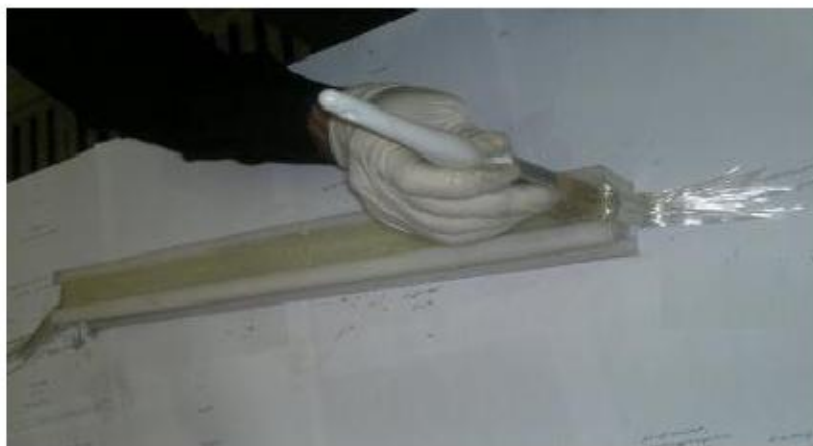
شکل ۱: نحوه لایه گذاری کامپوزیت پایه اپوکسی تقویت شده با الیاف شیشه.
