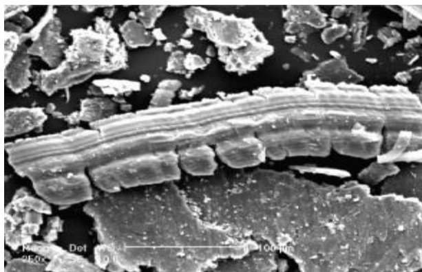
شکل ۱۰: ذرات سایش نمونه فلز پایه در بار ۱۰ نیوتن پس از طی مسافت ۱۰۰۰ متر
