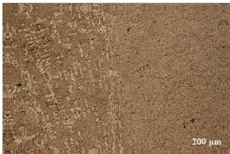
شکل 3- تصویر مربوط به فصل مشترک منطقه‌ی اغتشاشی با فلز پایه
