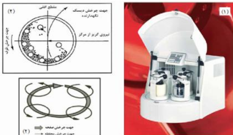
شکل ۱: (1) نمونه از آسیاب سیاره‌ای مجهز به چهار محفظه (2) شماتیک عملکرد و نحوه حرکت اجزای آسیاب [10].
