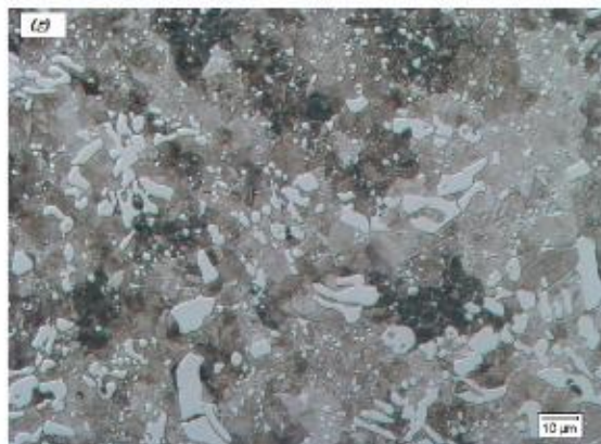
شکل ۲: تصاویر میکروسکوپ نوری با بزرگنمایی‌های مختلف فولاد مافوق کربنی استحکام بالا قبل از عملیات حرارتی
