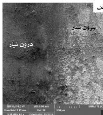
شکل ۵: تصویر SEM از سطح فولاد A216 پس از آزمون پلاریزاسیون سیکنی در محلول ۳/۵٪ NaCl (الف) ناحیه لبه شیار ساز (ب) ناحیه درون شیار
