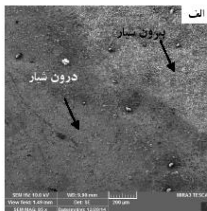
شکل ۵: تصویر SEM از سطح فولاد A216 پس از آزمون پلاریزاسیون سیکنی در محلول ۳/۵٪ NaCl (الف) ناحیه لبه شیار ساز (ب) ناحیه درون شیار
