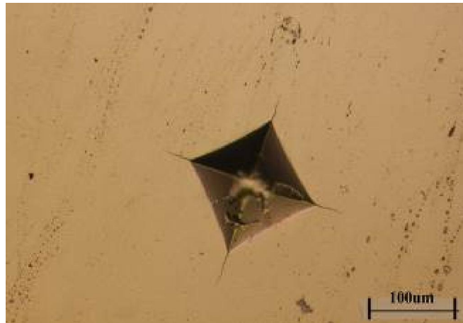
شکل ۲: تصویر میکروسکوپ نوری از اثر سختی سنجی ویکرز از نمونه WC-10%Co تجاری.
