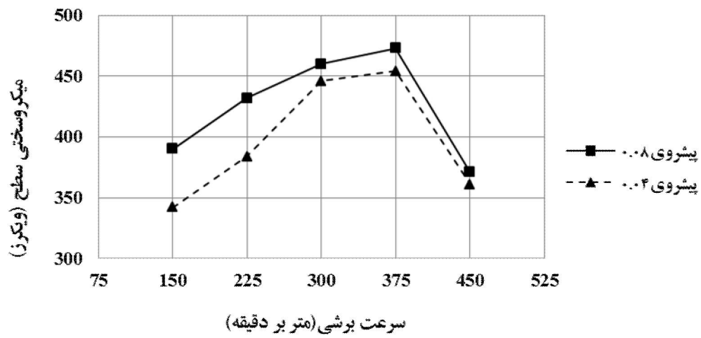
شکل ۴: تغییرات میکروسختی سطح ماشین کاری شده با سرعت برشی
