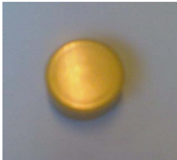
شکل ۲- نمونه پوشش دهی شده با TiN در دمای ۴۷۰°C و چرخه کاری ۳۳٪.
