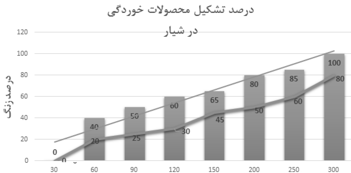
شکل ۶: میزان شوره سفید بر سطح نمونه‌های شیاردار بر حسب زمان در آزمون مه نمک.
