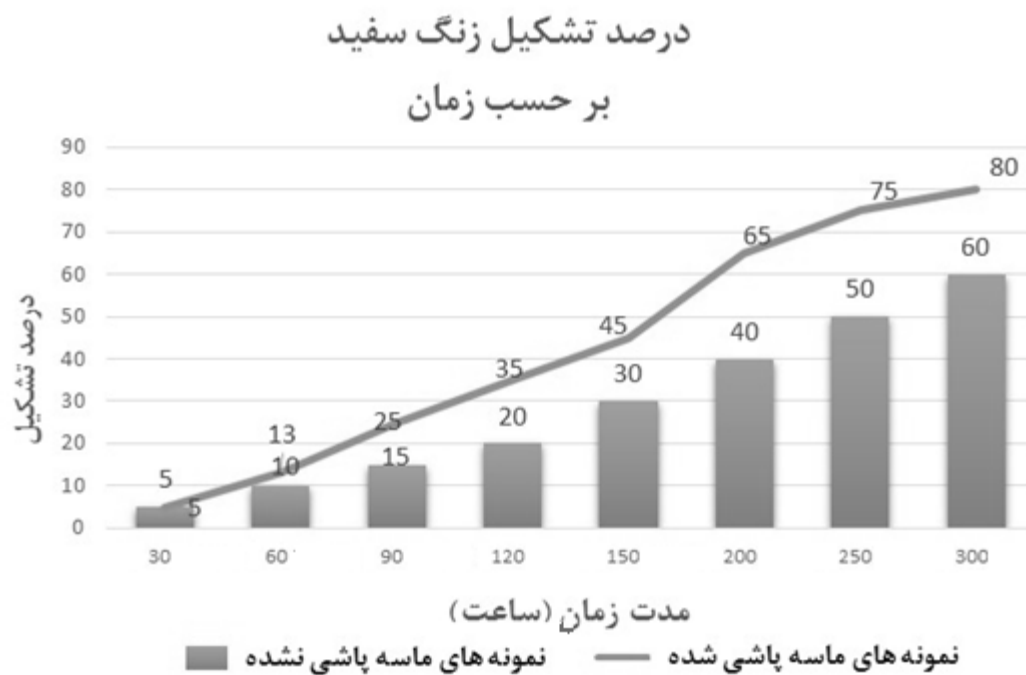
شکل ۵: میزان شوره سفید بر سطح نمونه‌های بدون شیار بر حسب زمان در آزمون مه نمک.
