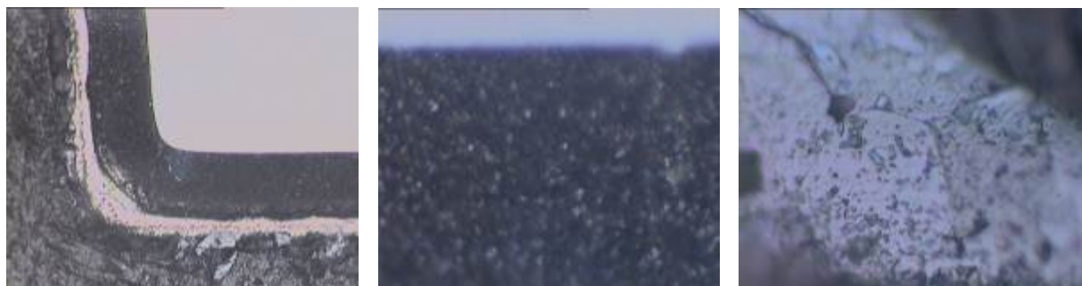
شکل ۱: تصویر میکروسکوپی نوری از نمونه آزمایشی پس از اچ در محلول ماربل
