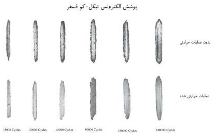
شکل ۹: تصویر مسیر سایش پوشش الکترولس نیکل-کم فسفر در شرایط با و بدون عملیات حرارتی
