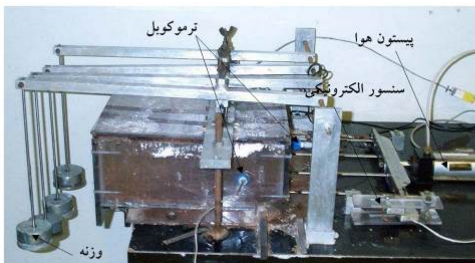
شکل ۱: تصویر دستگاه آزمون خوردگی سایشی (reciprocating corrosion and wear experimental)
