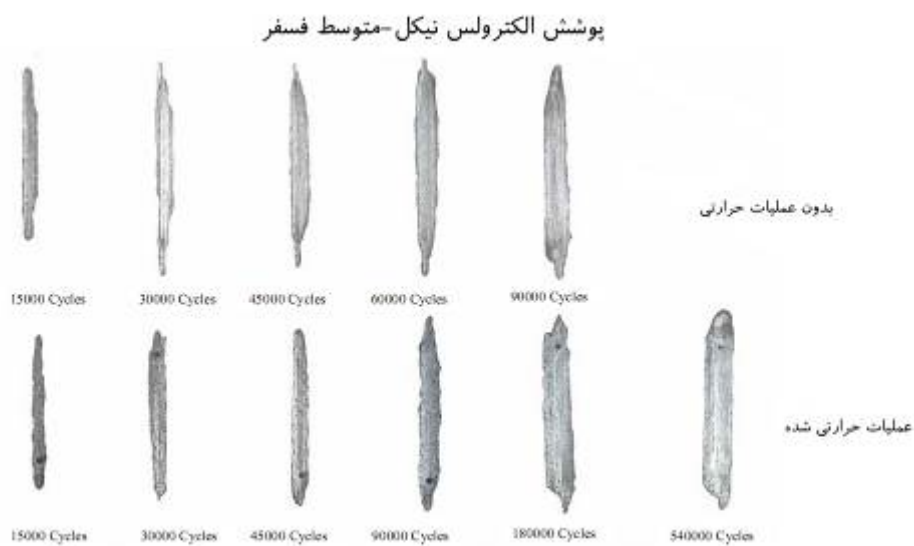
شکل ۸: تصویر مسیر سایش پوشش الکترولس نیکل-متوسط فسفر در شرایط با و بدون عملیات حرارتی
