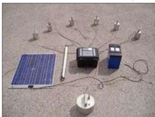
شکل ۱- سیستم دریافت کننده و سنسورهای روش انتشار آوایی و ریز لرزه نگاری
