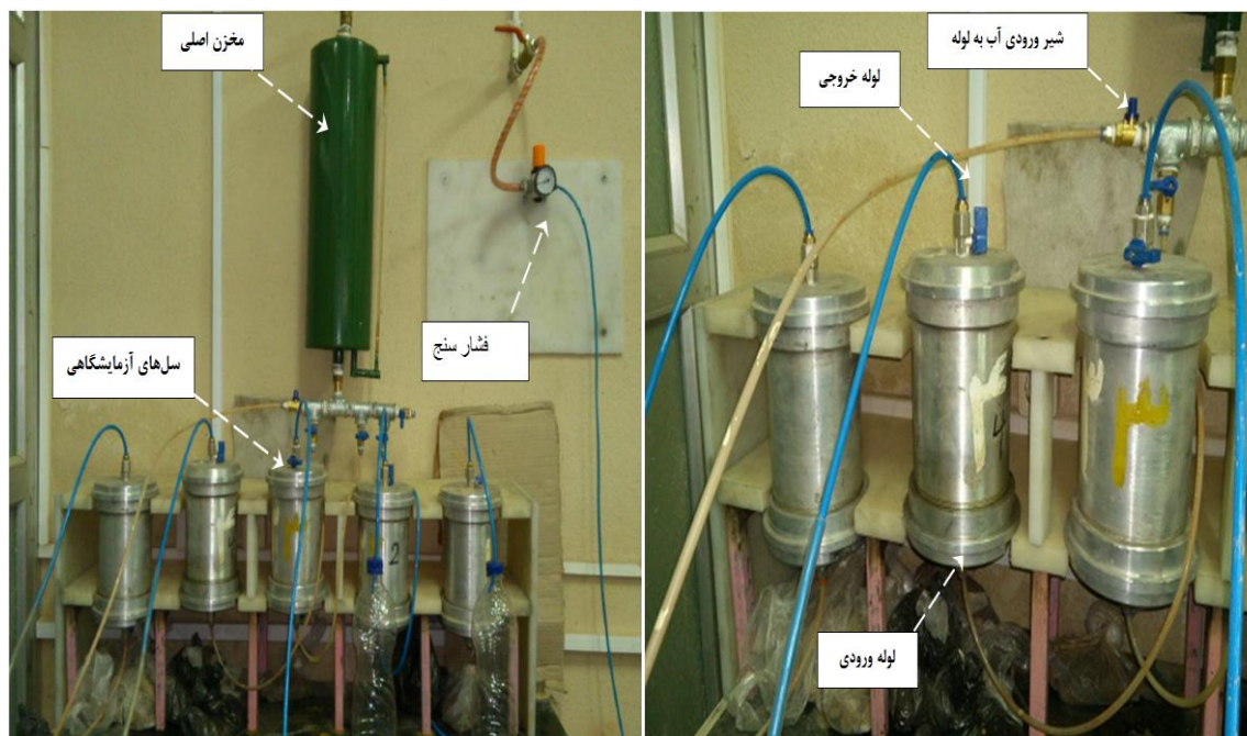
شکل ۱ شمای کلی دستگاه و سل‌های آزمایش و نحوه قرارگیری لوله های ورودی و خروجی
