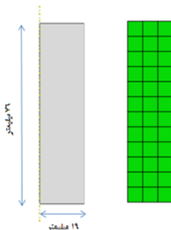
شکل شماره ۶- مدل تقارن محوری و مش مورد استفاده
