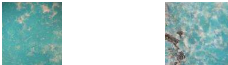
تصویر شماره ۶- لکه های سفید رنگ SiO_2 و هیدروکسید آلومینیم و رگه های تیره رنگ پیریت
