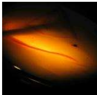
۵. ایجاد رنگ متمرکز در لایه های رشدی عقیق و ناخالصیهای پراکنده به روش موضعی
