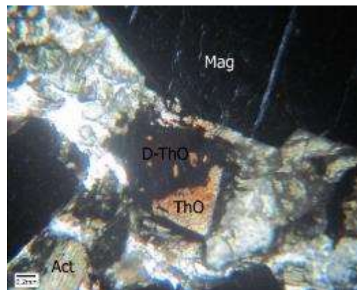
شکل ۳. سوختگی شدید توریت (ThO) که در آن بخش بزرگی از کانی تخریب شده است (D-ThO) (نور PPL).
