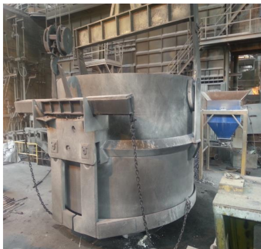
شکل ۱: یک نمونه سبد پیش گرم کن آهن قراضه با متعلقات
