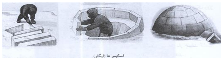
تصویر شماره (۲): مراحل ساخت خانه اسکی موها
