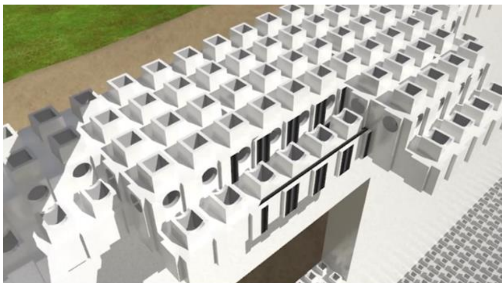
شکل ۸. اجرای سقف با آجرهای هوشمند ( http://kitebricks.com )
