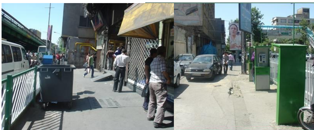
شکل ۱- کاهش عرض مفید به دلیل وجود عوارض در پیاده‌رو شکل ۲- موانع موجود در معابر پیاده
