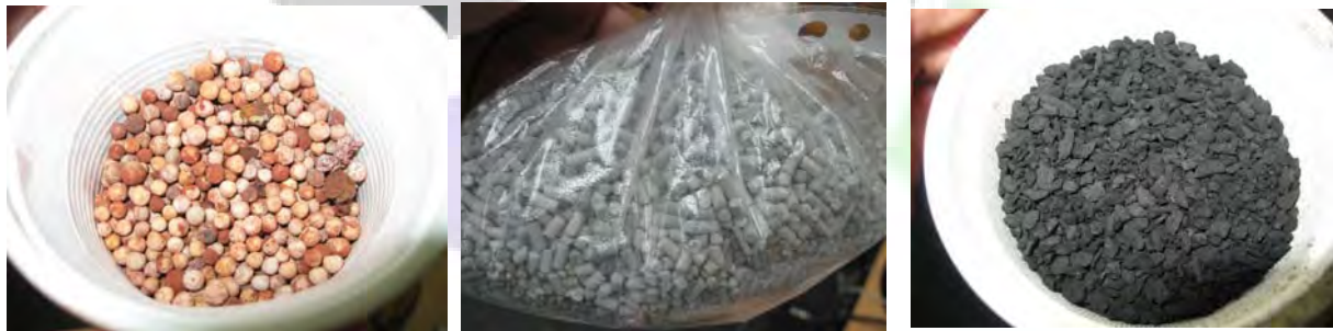
شکل ۳: نمونه‌ای از ضایعات تولیدی در فرایند پالایش گاز؛ (الف) زغال فعال؛ (ب) بستر غربال مولکولی؛ و (ج) کاتالیست
