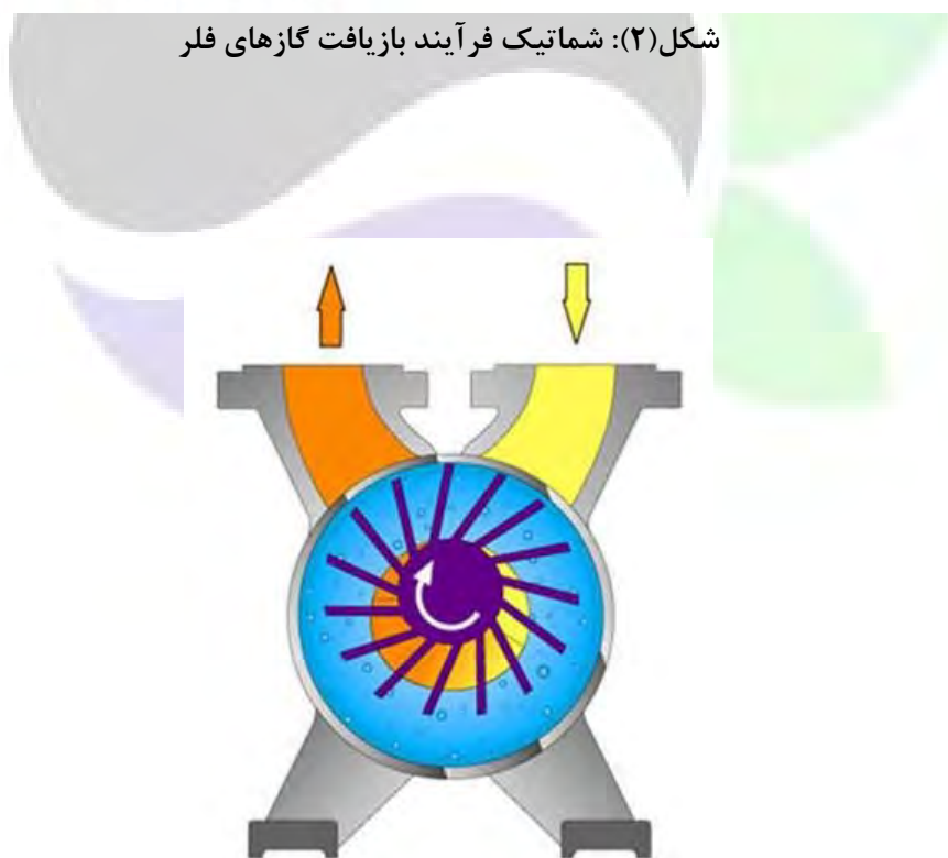
شکل (۳): نمونه ای از داخل سیستم کمپرسور چرخه مایع Liquid Ring Compressor
