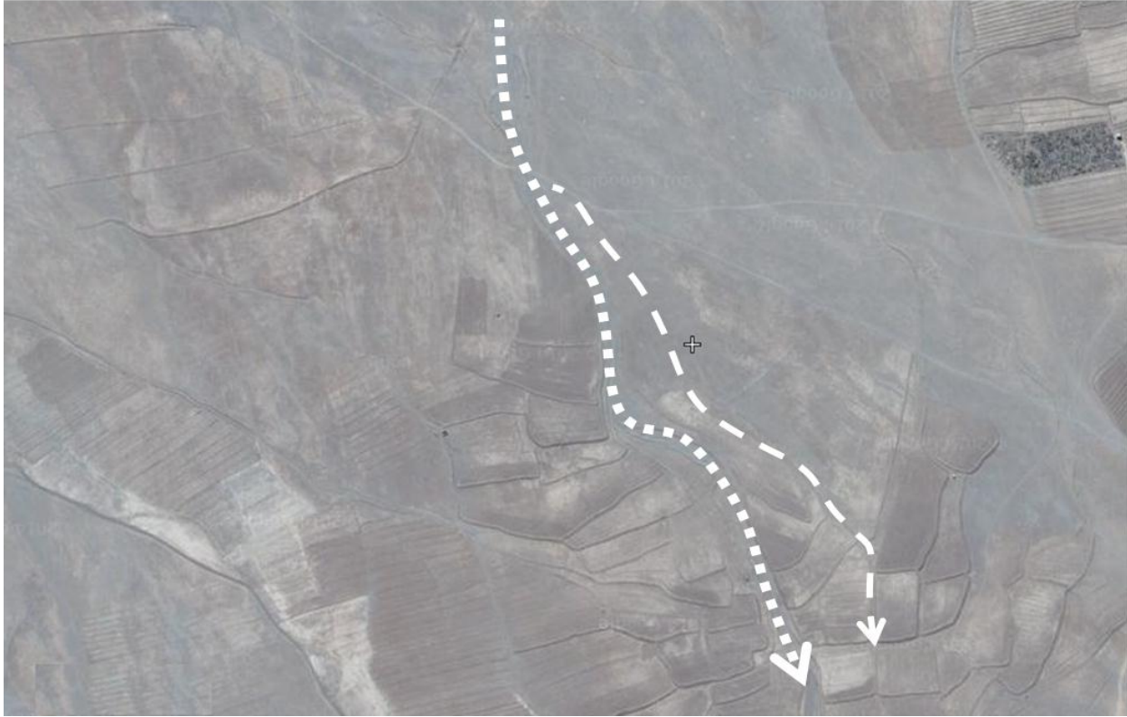
شکل (۲): نهر ایجاد شده با توجه به فاصله ی زیاد کال تا بند طویل می باشد نقطه چین پر رنگ کال و نقطه چین کم رنگ نهر ایجاد شده می باشد
