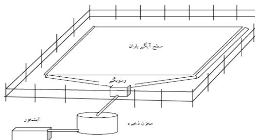
شکل ۳- نمایش شماتیکی اجزاء سیستم استحصال آب باران
