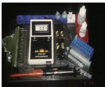
شکل ۷- دستگاه اندازه گیری بیولومینسانس به همراه متعلقات
