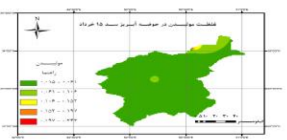
شکل (۱۹): نقشه پهنه‌بندی غلظت عنصر استرانسیم در حوضه آبریز سد ۱۵ خرداد شکل (۲۰): نقشه پهنه‌بندی غلظت عنصر مولیبدن در حوضه آبریز سد ۱۵ خرداد
