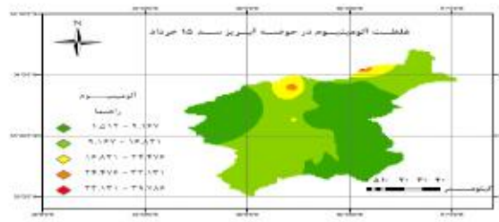
شکل (۵): نقشه پهنه‌بندی غلظت عنصر اسکاندیوم در حوضه آبریز سد ۱۵ خرداد شکل (۶): نقشه پهنه‌بندی غلظت عنصر آلومینیوم در حوضه آبریز سد ۱۵ خرداد
