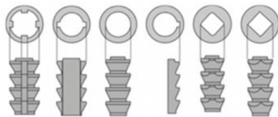
شکل ۱ نمونه‌هایی از پروفیل‌های جلویی ابزارهای خان‌کشی [۸]
