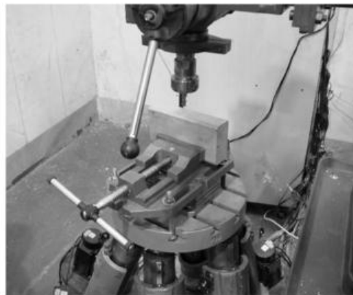
شکل ۱ مجموعه دستگاه هگزاپاد، فرز، گیره و قطعه کار
