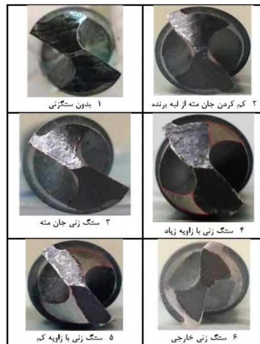
شکل ۲ طرح‌های مختلف سنگ‌زنی سر مته
