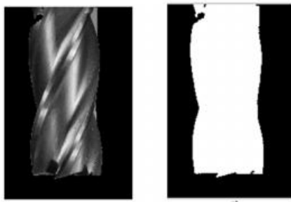
شکل ۳ تصویر قطعه‌بندی شده (الف) باینری (ب) خاکستری
