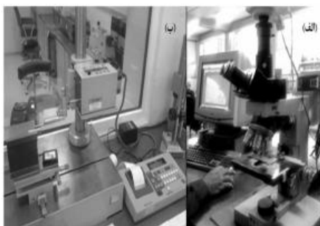
شکل ۲ تجهیزات آزمایشگاهی (الف) میکروسکوپ نوری (ب) زبری سنج
