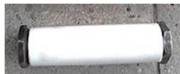
شکل ۴ پوسته پلی آمیدی نگه دارنده برس ساینده و قطعه‌کار
