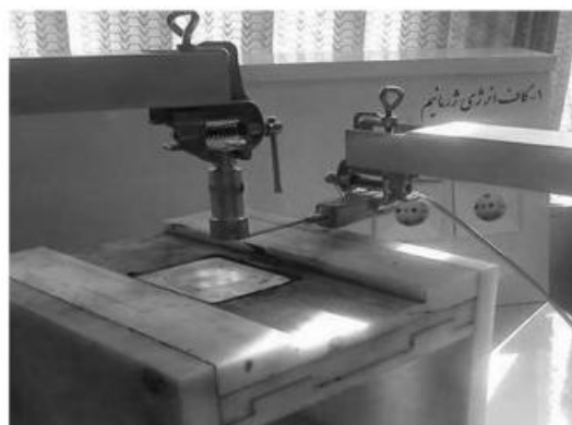
شکل ۱ نحوه انجام اندازه‌گیری چگالی شار مغناطیسی توسط تسلا متر
