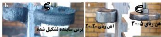
شکل ۳ (a) مکانیزم به کار رفته (b) برس سایبند تشکیل شده در حین انجام آزمایش
