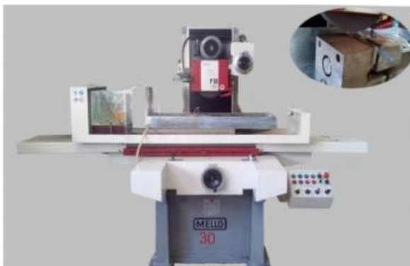
شکل ۱ تجهیزات سنگ زنی به کمک ماشین کاری شیمیایی
