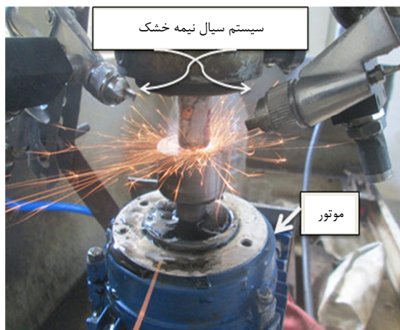
شکل ۱ نمایشی از سیستم پاشش سیال و موتور نصب شده بر روی میز
