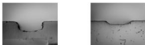
الف) در ولتاژ ۲۲۷، عمق شیار ۹۴ \mu\text{m} (ب) در ولتاژ ۲۶۷، عمق شیار ۲۵۴ \mu\text{m} شکل ۵ نمونه تجربی از ولتاژهای پالسی متفاوت
