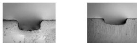
الف) در ولتاژ ۲۲۷، عمق شیار ۱۷۲ \mu\text{m} (ب) در ولتاژ ۲۶۷، عمق شیار ۲۷۵ \mu\text{m} شکل ۲ نمونه تجربی از ولتاژهای پیوسته متفاوت
