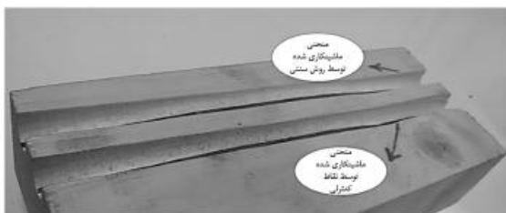
شکل ۱۱ منحنی ماشین کاری شده توسط دو روش نرئز و سنتی
