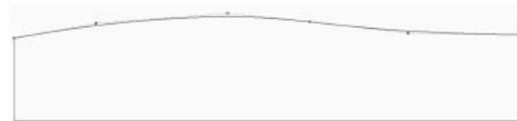
شکل ۴ شبیه‌سازی منحنی در محیط نرم‌افزار راینو با نقاط کنترلی آن
