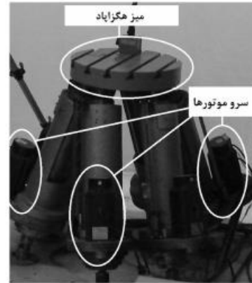
شکل ۳ نمونه آزمایشگاهی هگزاپاد ساخته شده در دانشگاه تربیت مدرس
