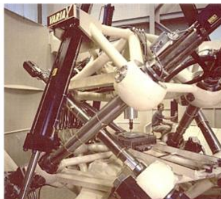
شکل ۱ نمونه‌ای از دستگاه واریاکس ساخت شرکت گیدینگ و لوئیس [۵]
