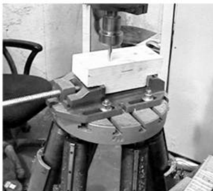
شکل ۷ مجموعه دستگاه هگزاپاد، فرز و گیره‌بندی در حین ماشین‌کاری
