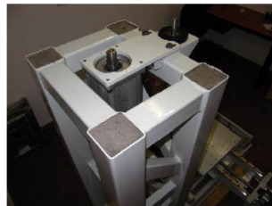
شکل ۱ قسمتی از یک سازه‌ی فولادی ماشین‌ابزار توپرسازی شده توسط بتن [۴]
